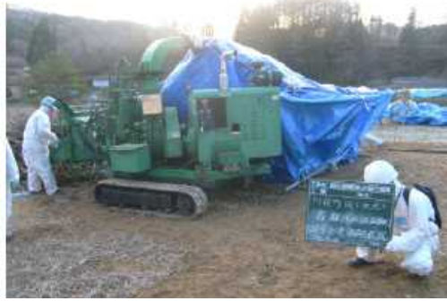
図 2-20 破碎機（チッパー）による減容化（例）
